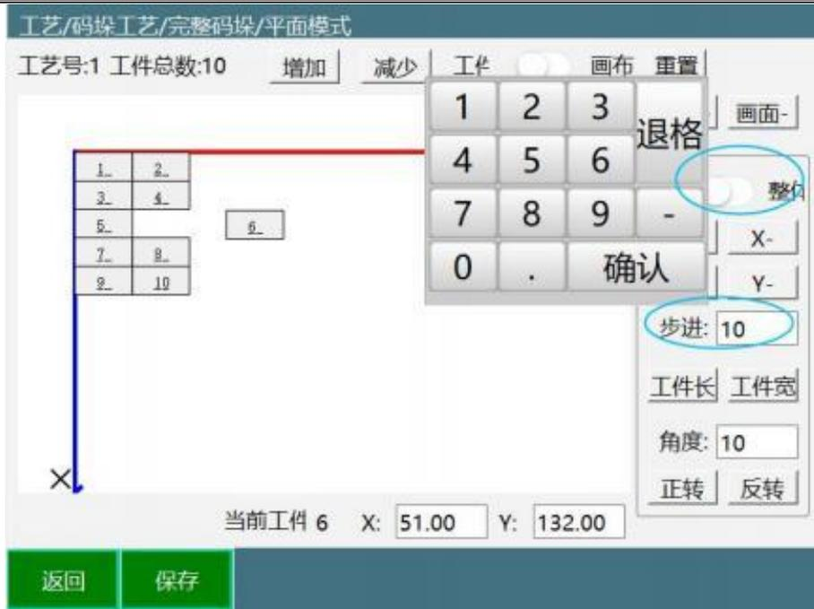
3.选中工件，点击X+。例如选择工件6，点击X+，工件往X轴正方向偏移10mm
