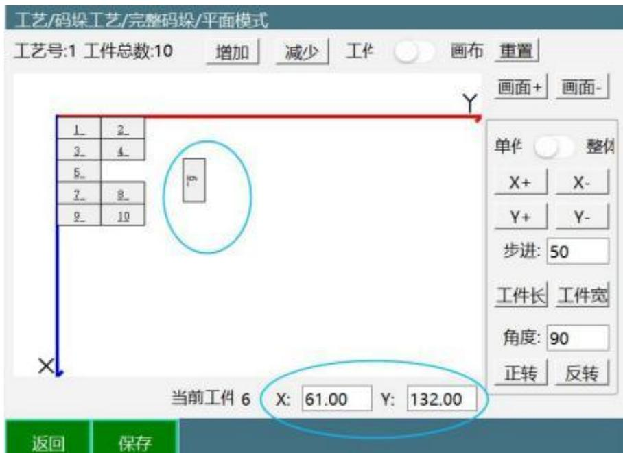
2.X轴填100，Y轴填200，可以看到，工件已偏移到填写的位置。
