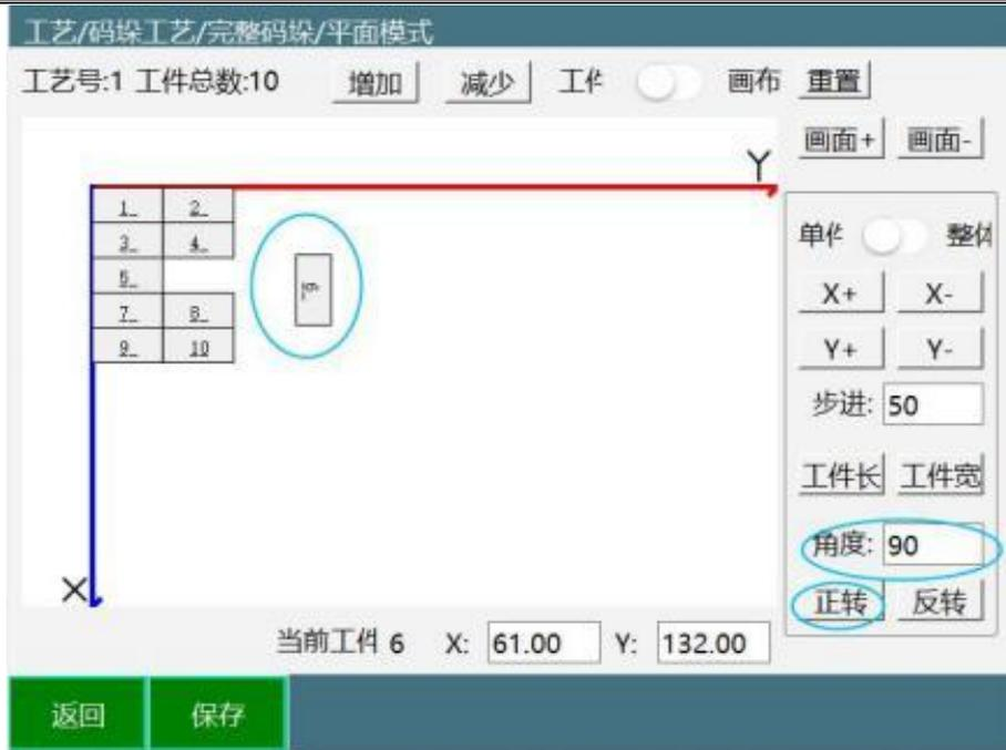
7.例如角度填90，点击正转，工件顺时针旋转了90度；反转使用方法与正转一致。
