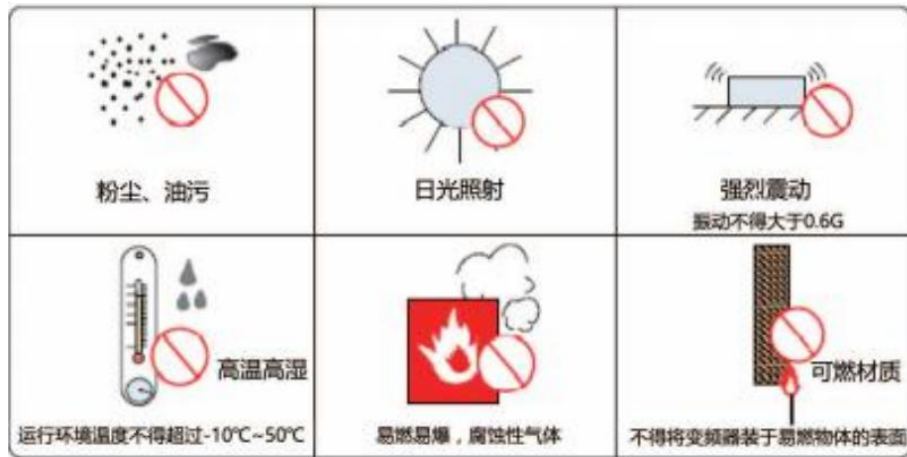
图2-2控制柜安装要求图
