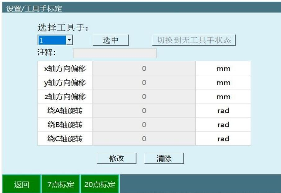
若有工具的详细参数，在该界面下，用户可以直接填写工具末端偏移的相关参数，不需进行七点标定。
