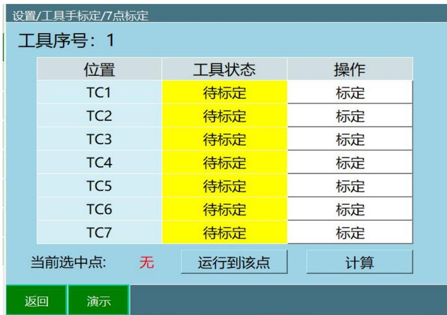
若没有工具的详细参数，可以进行TCP标定，自动计算出工具各项尺寸参数。具体标定步骤如下：
