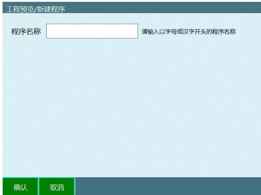
2. 点击底部的【确定】按钮，程序创建成功，并跳转入新建的程序。
