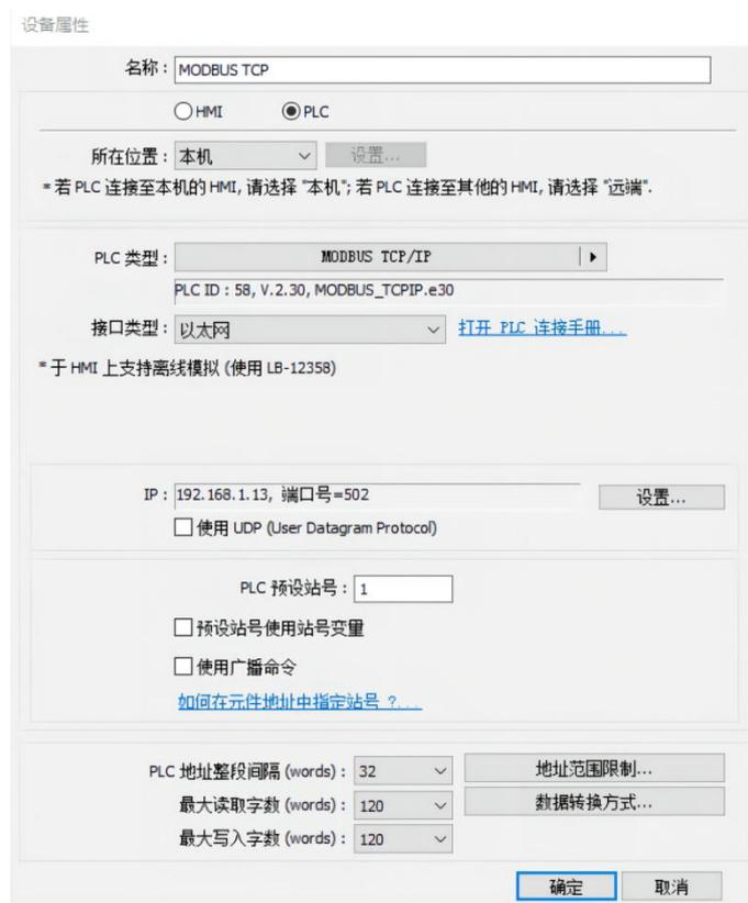
触摸屏程序编辑好后运行, 示教盒远程界面modbus未连接变为modbus已连接。
