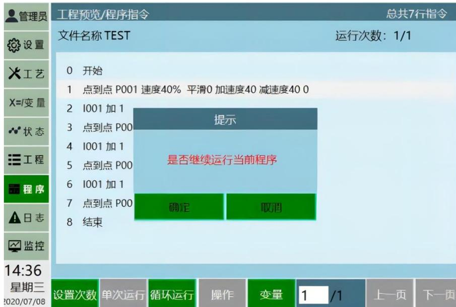
**断点状态查看：**断点后切换到示教模式后，可以通过上电查看断点时的位置/数值变量状态。
