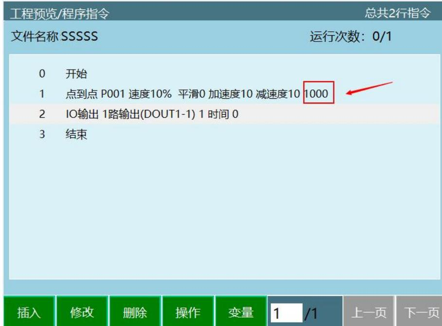
上图示例程序中，MOVJ指令后插入DOUT指令；MOVJ指令TIME参数填1000ms，则运行时会提前1s执行下一条指令，例如MOVJ指令会执行3s，则MOVJ指令运行2秒执行DOUT并继续执行MOVJ到P001。
