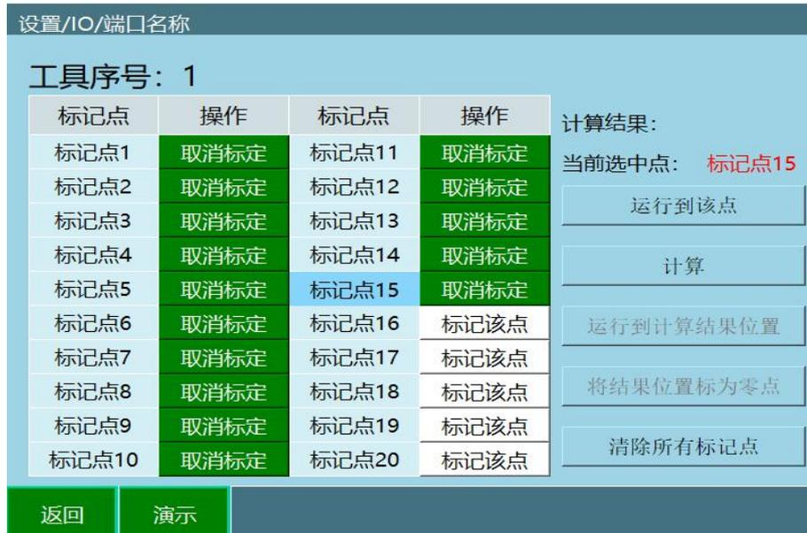
找到一个参考点（标定锥尖端为参考点），并确保此参考点固定。开始插入位置点，每插入一点，点击【标记该点】，插入十五个点具体步骤如下：
