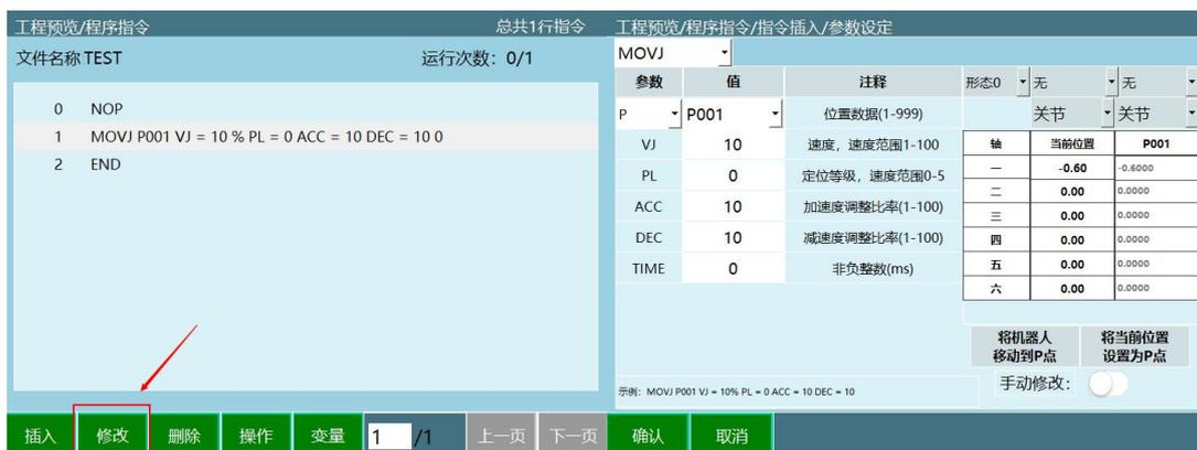
2. 当前位置列显示当前选中的坐标系下的机器人位置；P001列显示P点选中坐标系下的机器人位置
