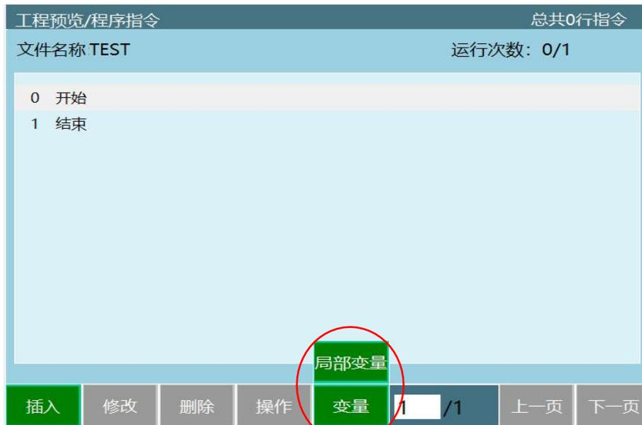
数值型变量储存的是数值，包含了整数型变量、实数型变量、布尔型变量三种。定义的所有局部数值变量都只能用于当前程序，其他程序、后台程序都无法使用。
