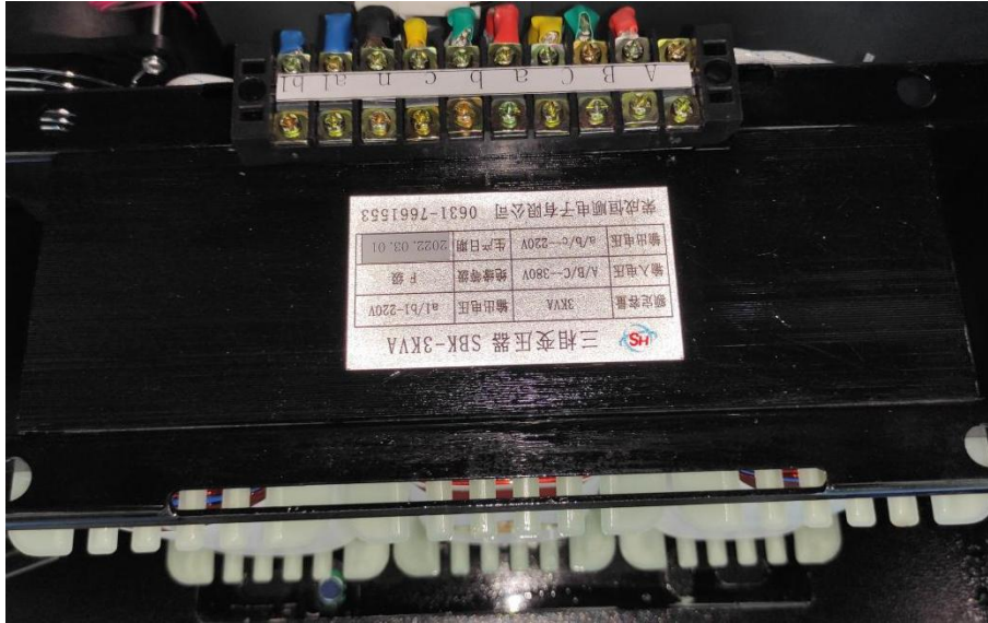
图3-6 隔离变压器俯视图
