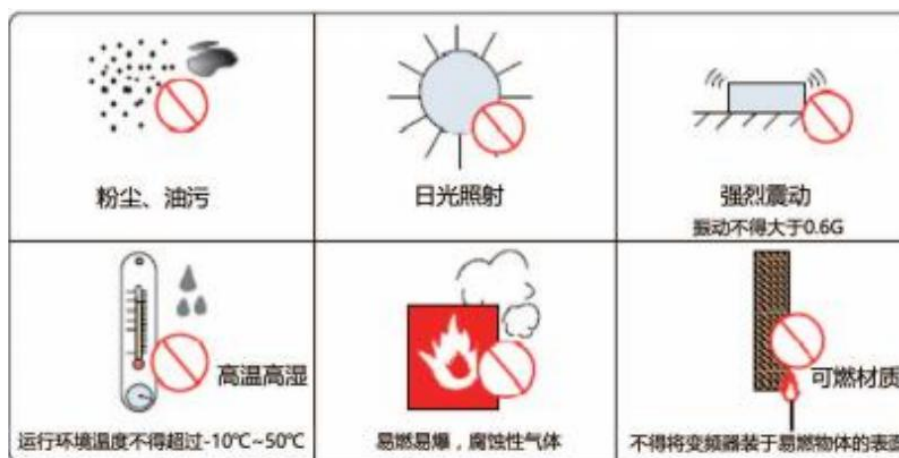
图2-2控制柜安装要求图
